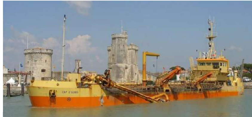
Canon à sédiment (rechargement de plage)
