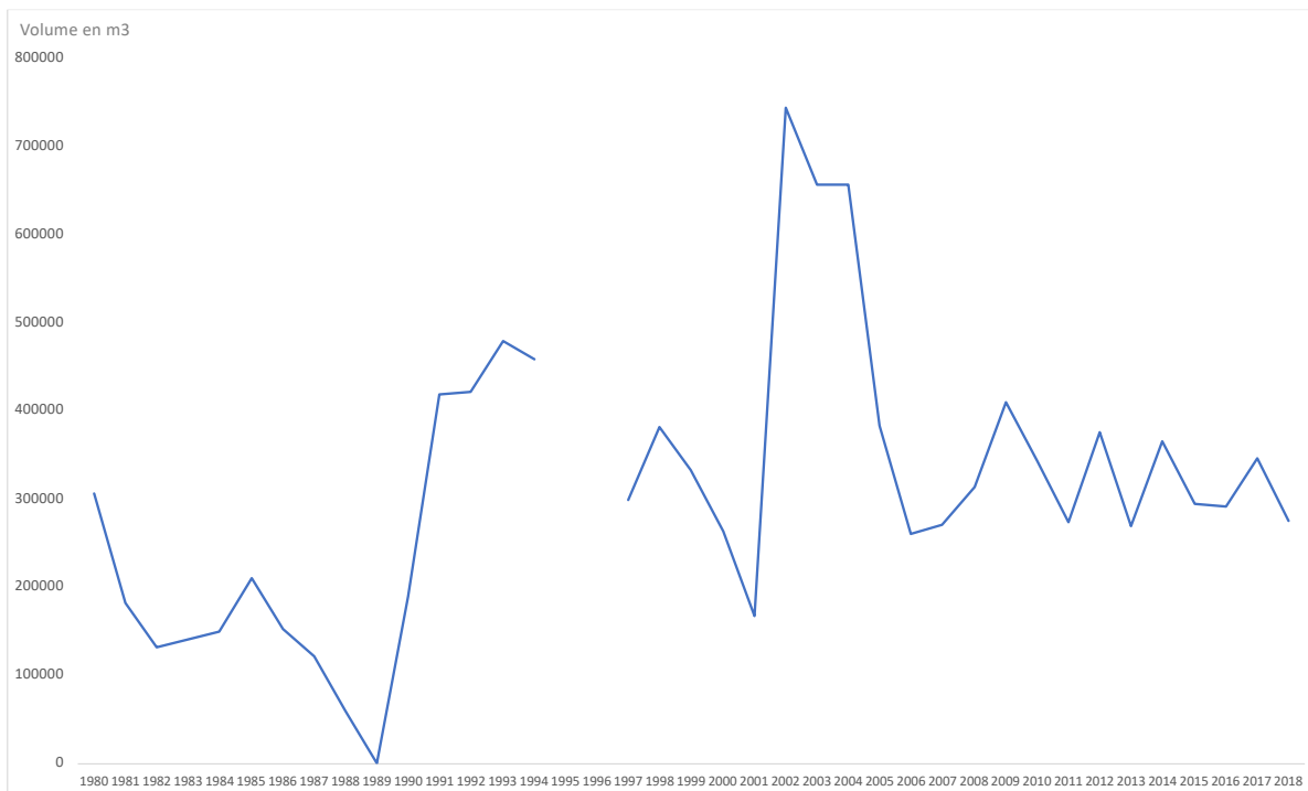
Figure 46 : Évolution des volumes de sédiments immergés sur le site du Lavardin entre 1980 et 2018
